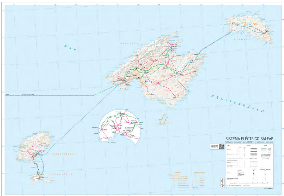
FIGURA 8.14. XARXA DE TRANSPORT ELÈCTRIC A LES ILLES BALEARS
